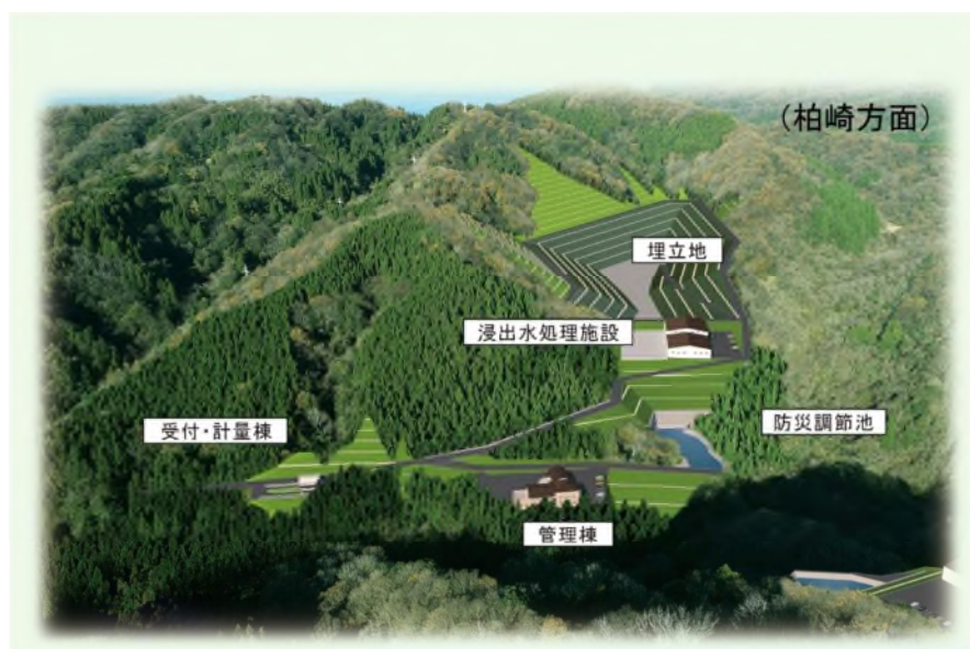
図 1.4-3 竹鼻地区埋立地の施設配置イメージ
