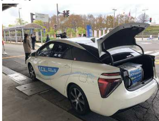
外部給電デモ
