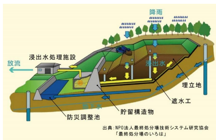
図 3.3-1 管理型最終処分場概要図
